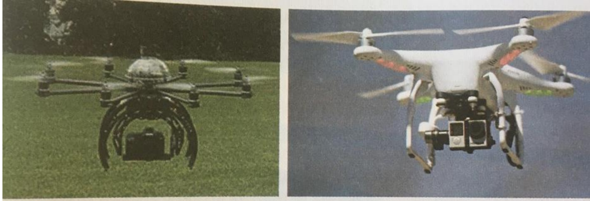
Şekil 109. Sekiz rotorlu İHA; Ticari İHA (quadcopter, DJI'nın Çin malı kamera ürünüdür)
