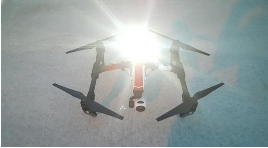
Şekil 122. İHA için aydınlatma sistemi
