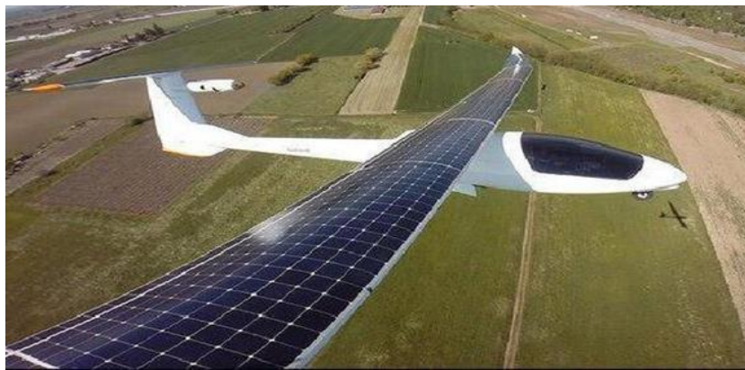
Şekil 34. Uçak üstünde güneş panelleri
